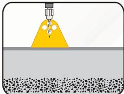
Colocar la pieza y sobre orificios del delineador perforar con taladro y broca para concreto de ½ x 10" a 11cm de profundidad (aproximada).
