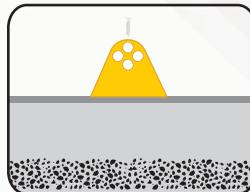
Ya perforado se coloca el taquete expansivo en orificios del concreto dejando 2 cm de cuerda al ras de piso. Con taquetes colocados en piso sin tuerca, se coloca el tope coincidiendo con orificios de taquetes en piso.
